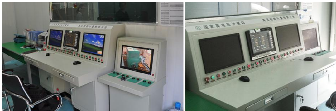
图3 用于“节能产品惠民工程”高压高效电机全国范围能效抽查的银河电气SMT标准化电机试验台
